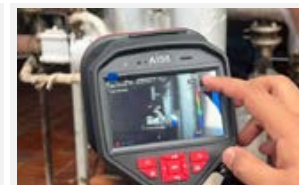
ガス漏れ検知
